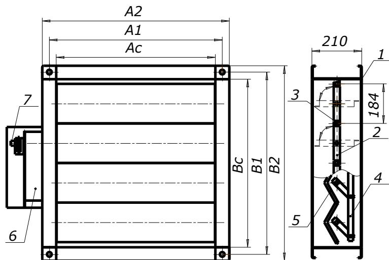
1 – корпус клапана, 2 – лопатка, 3 – трубчатый электронагреватель (ТЭН), 4 – поворотный механизм, 5 – электрическая шина, 6 – привод, 7 – ведущая ось вращения лопаток.
